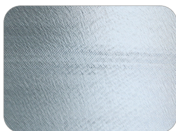
Superficie con vibrazione R_a = 0.7 \mu m
