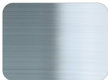
Superficie senza vibrazione R_a = 0.35 \mu m
