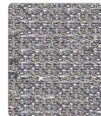
Dank der Spanteiler ist keine Rille sichtbar, wie dies bei Verwendung eines konventionellen Fräasers der Fall wäre. Das Ergebnis ist die beste Oberflächenqualität.
