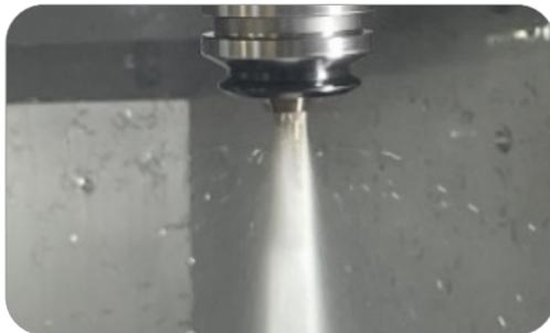
Das im Schaft integrierte patentierte Kühlmittelsystem des CrazyDrill Titanium TK ermöglicht prozesssicheres Bohren mit hohen Vorschüben bei 15bar Kühlmitteldruck. Auch die Standzeit der CrazyDrill Titanium TK setzt gegenüber den Mitbewerbern einen neuen Benchmark. Und für Anwendungsfälle ohne die Möglichkeit einer inneren Kühlmittelzuführung hat Mikron Tool den Hochleistungs-Mikrobohrer CrazyDrill Titanium TN entwickelt, der konsequent auf externe Kühlschmierstoffversorgung hin ausgelegt wurde.
