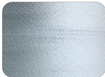
Oberfläche mit Vibration
